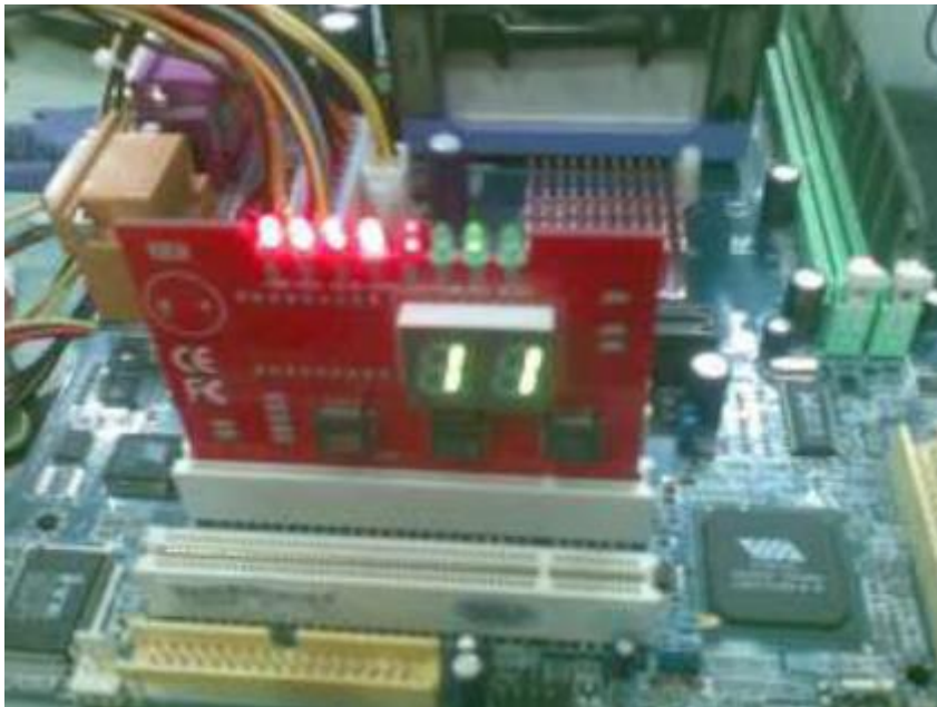
شكل رقم ٩٨: تثبيت كارت الاختبار
