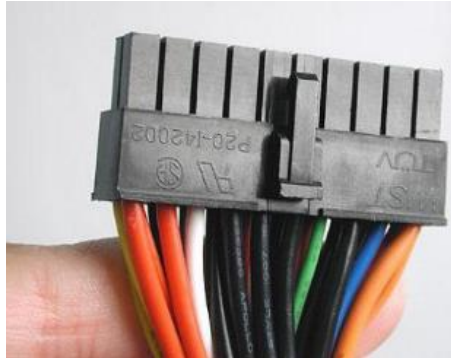
شكل رقم ٧١: شكل موصل ATX
