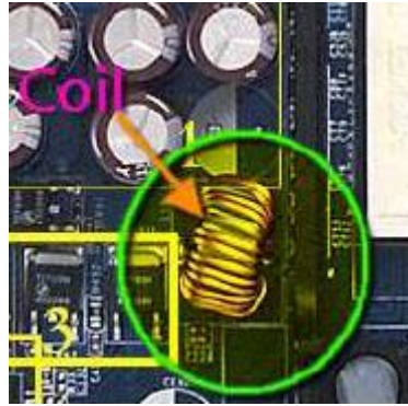
شكل رقم ٨٧: فحص ملفات اللوحة الام
