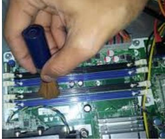
شكل رقم ٨: تنظيف اللوحة الأم بالفرشاة
